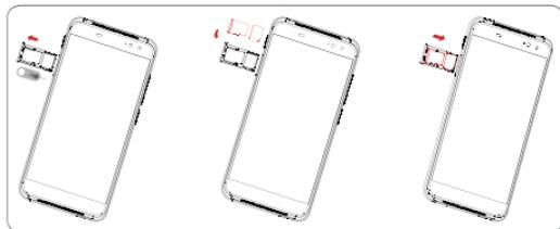
Antes de instalar ou remover o cartão SIM ou o cartão microSD, utilize um clipe para premir a pequena cavidade até abrir a ranhura do SIM/microSD. Coloque o cartão SIM com o chip virado para baixo e faça-o deslizar na ranhura. Certifique-se de que foi inserido corretamente.
