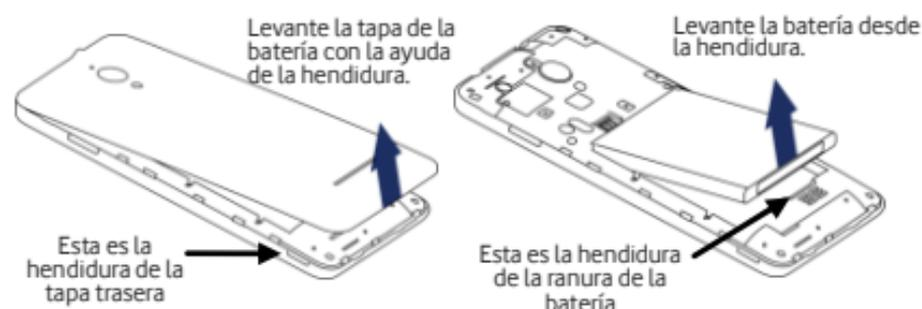
**Extraer la tapa trasera:** sujete con firmeza los laterales del teléfono. Con la ayuda del pulgar y de la hendidura, levante la tapa trasera.
