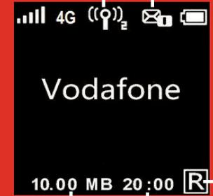
Indicación acumulativa del volumen de datos cargados o descargados
