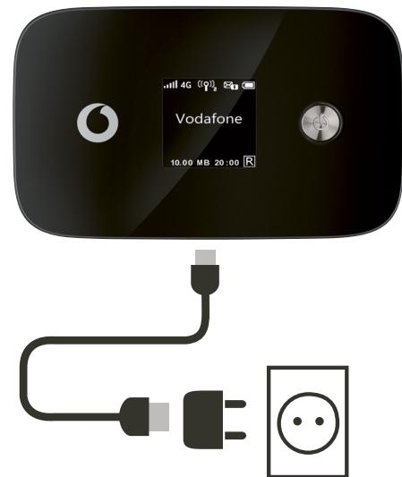
Σημείωση: μπορείτε να χρησιμοποιήσετε και τη θύρα USB του υπολογιστή σας για τροφοδοσία.
